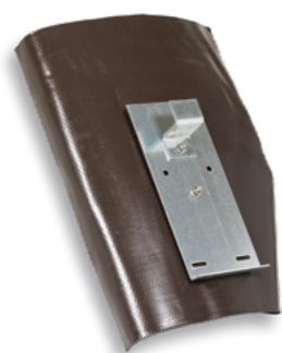
Die Lieferung der Dachpfanne erfolgt inklusiv rückseitiger, lastabtragender Stahlplatte, an der ein Z-Profil für die Windsogsicherung bereits werksseitig befestigt ist.
